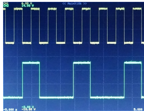
図 11 LED 点灯のパターンとデジタルオシロスコープによる波形観察の様子
